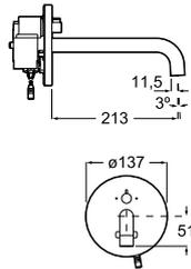
Mezclador electrónico para lavabo con sensor integrado.
