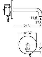
Mezclador electrónico para lavabo con sensor integrado.
