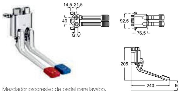
Mezclador progresivo de pedal para lavabo.
