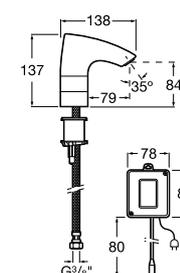
Grifería electrónica para lavabo (un agua) con enlace de alimentación flexible. Cromado.
