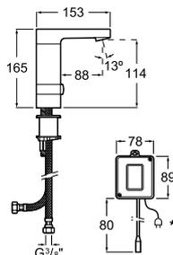
Mezclador electrónico para lavabo con limitador de caudal y enlaces de alimentación flexibles. Cromado.
