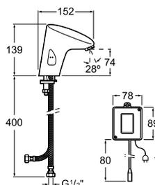
Mezclador electrónico para lavabo con aireador y enlaces de alimentación flexibles. De detección corta. Cromado.
