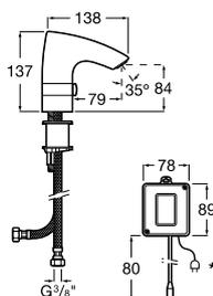
Mezclador electrónico para lavabo con enlaces de alimentación flexibles. Cromado.
