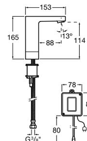
Grifería electrónica para lavabo (un agua) con limitador de caudal y enlace de alimentación flexible. Cromado.
